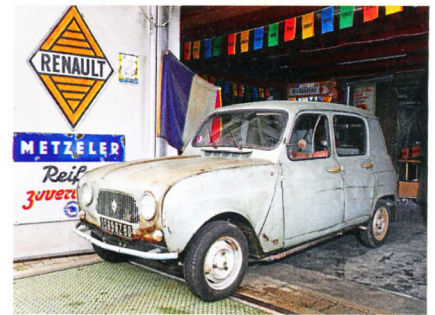
Speziell in den Türen kann sich Wasser sammeln und zur Durchrostung führen
