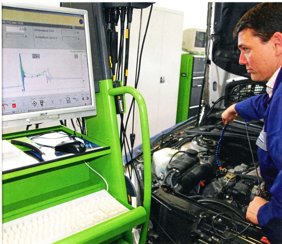
Bild 6 Wer das Zündungszilloskop beherrscht, hat gute Chancen, bei Youngtimern Störungen im Zündsystem und beim Verbrennungsprozess in kurzer Zeit aufzudecken
