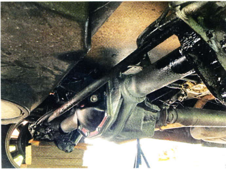
Hinterachsantriebe und Kardanwellen können ausgeschlagen sein. Heftiges Lagerkreischen, heulende Geräusche oder Vibrationen deuten darauf hin
