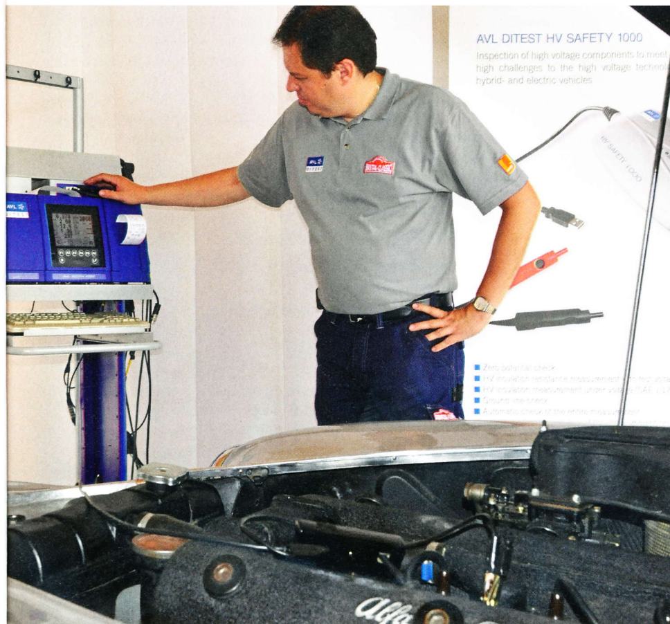
Bild 8 Der Abgastest gibt Auskunft über die Gemischzusammensetzung. Für die Einstellung des Vergasers oder der Einspritzanlage ist er unerlässlich
