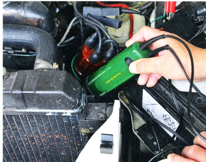
Bild 5 Der Zündzeitpunkt wird mit einer Zündlichtpistole geprüft. Beim Anblitzen der Riemenscheibe oder Schwungscheibe wird die Zündmarkierung sichtbar. Sie muss der Festmarke gegenüberstehen
