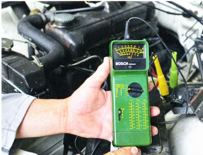
Bild 4 Der Schließwinkel verändert sich mit zunehmender Laufleistung. Liegt er außerhalb der Toleranz, muss der Unterbrecherkontakt geprüft und gegebenenfalls ersetzt werden
